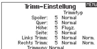
Die Trimmeinstellungen erlaubt es den Trimbereich der Servos in unterschiedlich große oder kleine Trimmsschritte einzuteilen und den Trimmtyp zu ändern.
